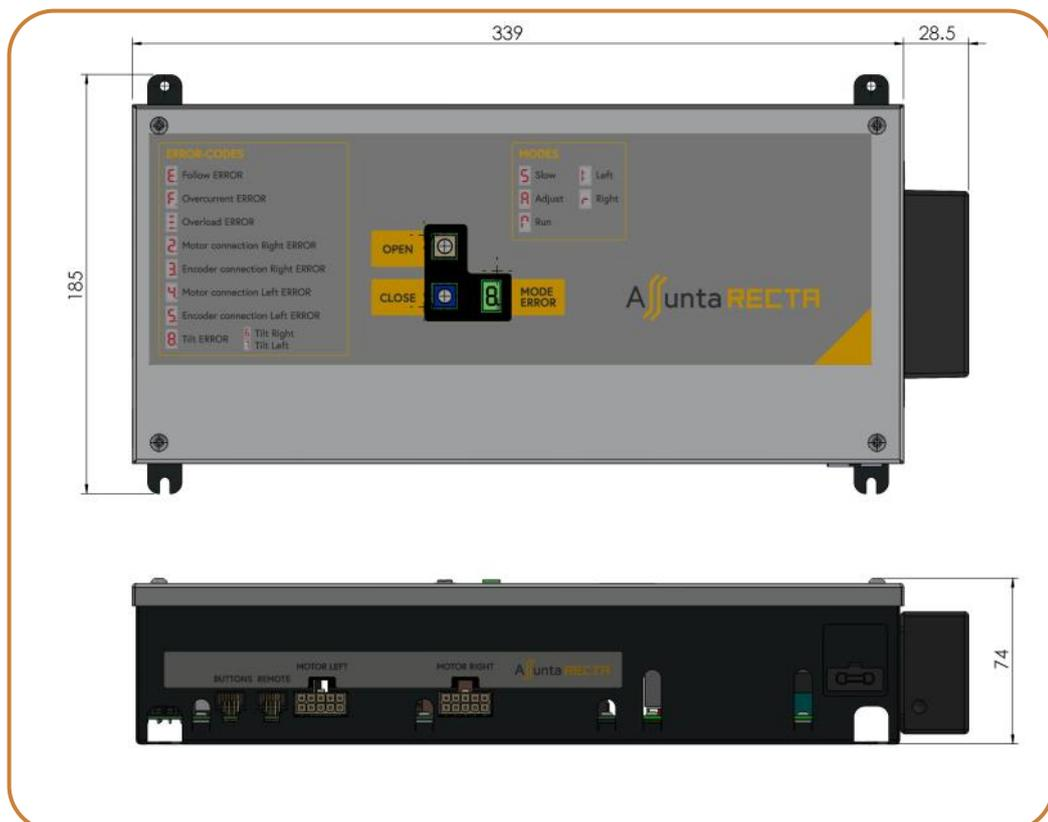
Das Steuergerät kann im Technikraum hinter der feststehenden Tafel angebracht werden. Die 2 m langen Motorkabel sind für diesen Zweck ausreichend lang. Es ist natürlich noch bequemer (im Falle einer Störung), den Schaltkasten außerhalb des Schaltschranks zu montieren, aber dann müssen längere Motorkabel von 4 m vorgesehen werden.
